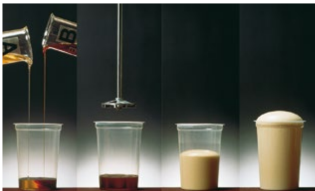
Čtyři fáze napěnění tvrdé polyuretanové pěny.
